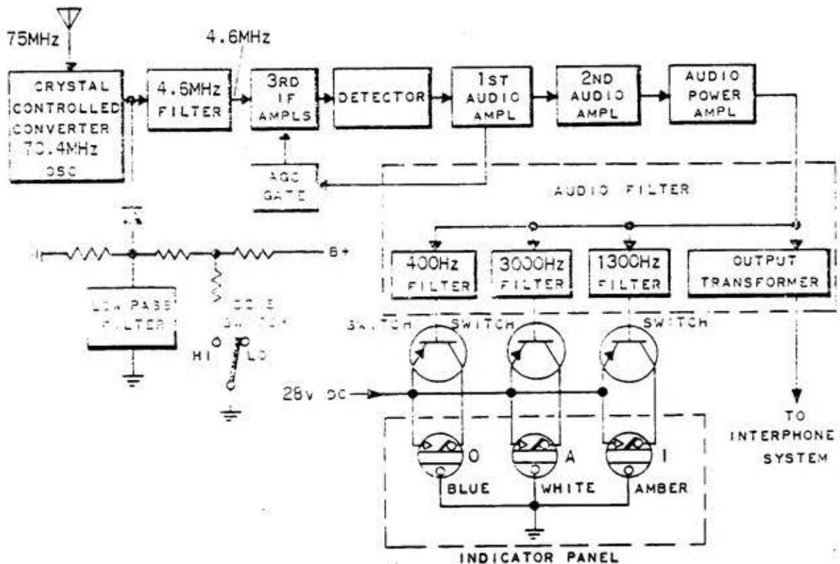
MARKER BEACON RECEIVER BLOCK DIAGRAM
